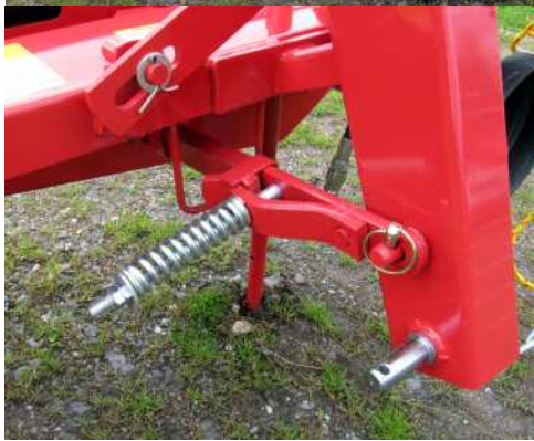
Agrow niittokoneissa on rungon laukaisulaite törmäyssuojana.
