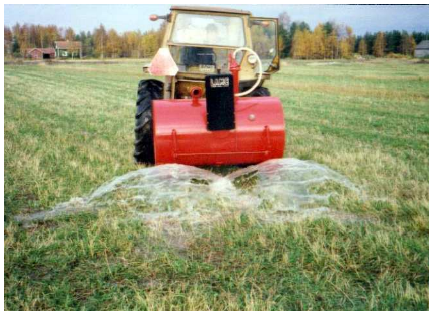
Nostolaitesovitteinen imusäiliö virtsan levitystä varten
